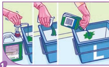
Remplir un seau de lavage avec 8 litres d'eau. **Dilution à 0,25%** : Verser une dose de 20 ml de DETERG'ANIOS dans le seau.
